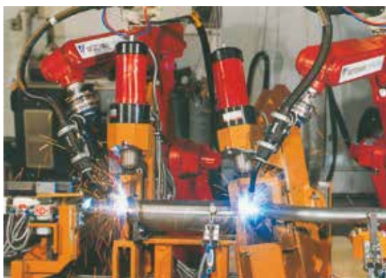
Schweißvorrichtung für Schalldämpfer-Komponenten
