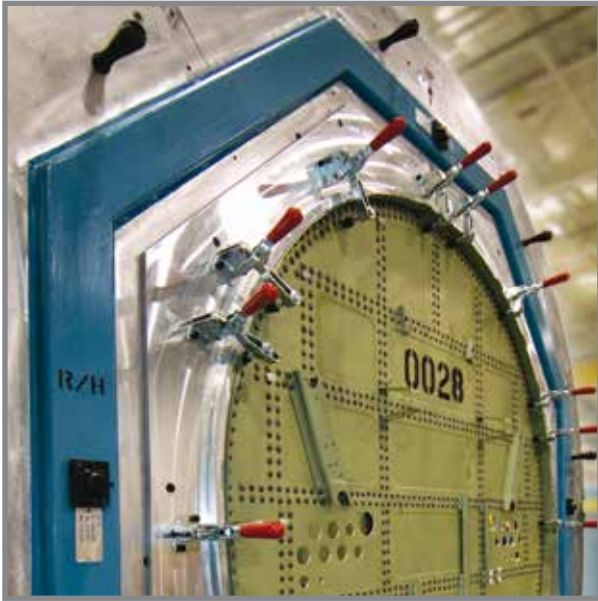
Modell 210-U in einer Montagevorrichtung der Flugzeugindustrie
