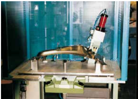
Stanzanlage für Löcher \varnothing 8 in PKW-Fahrzeugteile aus Stahlblech
