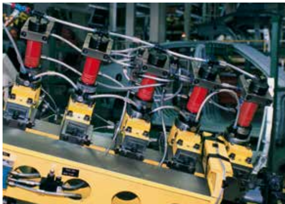
Reihenstanzanlage für Stahlblechteile
