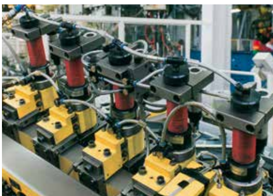
Reihenstanzanlage für Stahlblechteile
