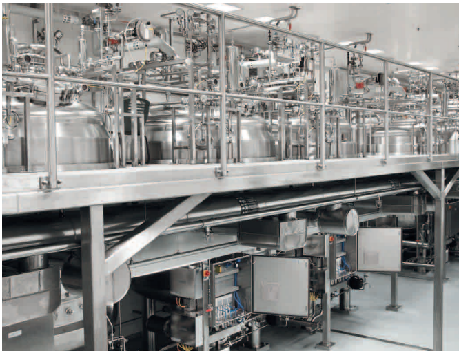
Zukunftsträchtige Kombination: Bioreaktoren und Automatisierungstechnik mit CPX/MPA Ventilinseln von Festo im einbaufertig gelieferten Schaltschrank.
