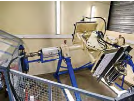
Druckspeicher-Prüfstand für Windkraftanlagen.
